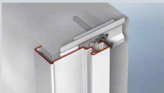
Hoekkozijn-profiel 1 vastschroeven op de systeemwand
