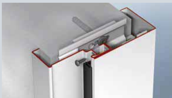
Tegenkozijn-profiel 2 van het kozijn door de afdichtingssponning met profiel 1 vastschroeven en met de deurafdichting bedekken
